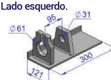
Travessa de ligação truck TE Guerra. Lado esquerdo.
