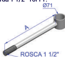
Ponteira maior do braço Tensor regulável Ø71mm Guerra Nakata. Rosca esquerda 1 1/2" 10FPP.
