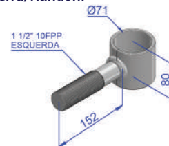
Ponteira do Braço tensor soldado Ø71mm Guerra/Randon.
