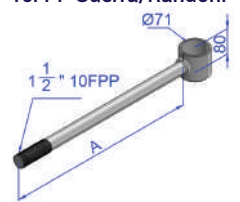
Ponteira do Braço tensor soldado Ø71mm, rosca direita 1 1/2" 10FPP Guerra/Randon.
